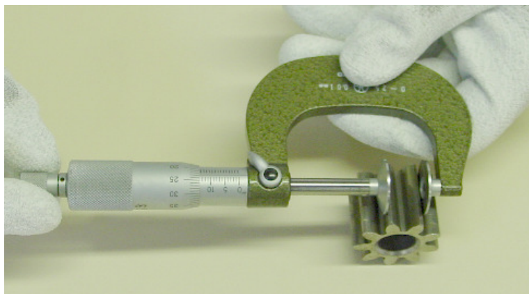
Figura 1 – Medição da espessura do dente através da medição do Wk
