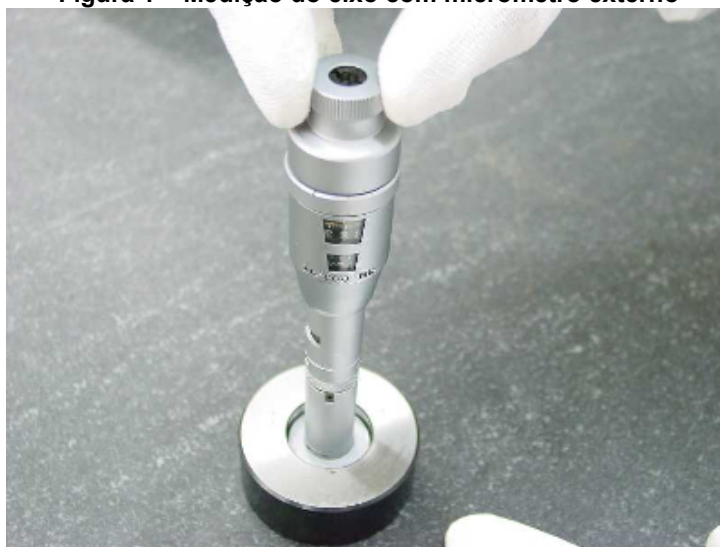
Figura 2 – Medição do furo com micrômetro interno
