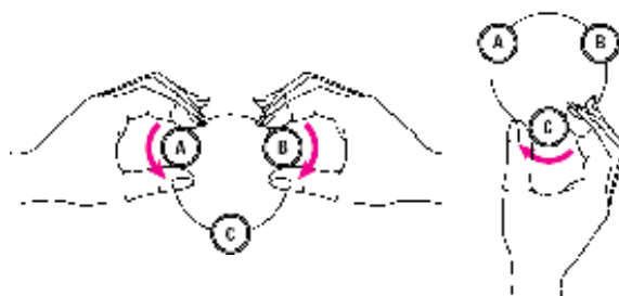
Figura 5: Procedimento para calagem do nível tórico
