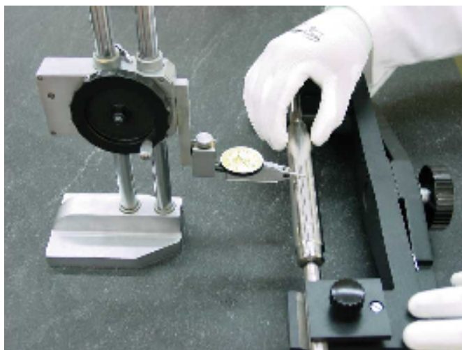
Figura 5 - Controle do desvio de batimento circular radial
